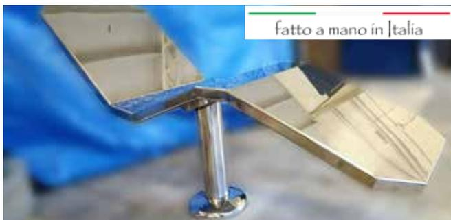
Seduta aeromassaggio costruita in acciaio Inox AISI 316 completo di colonna centrale per sostegno e contropiastra a murare con manicotto 2"1/2 per distribuzione dell'aria con microfori da 3mm.
