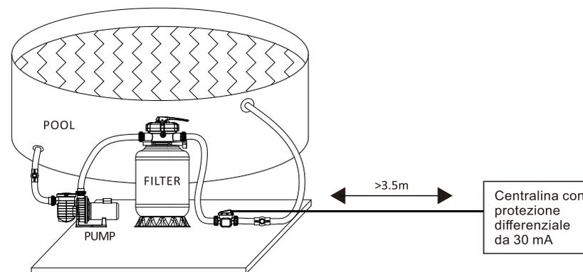
L'unità di alimentazione dell'elettrolizzatore al sale deve essere installata su una fonte di alimentazione indipendente, dotata di una protezione differenziale di 30 mA, al riparo dalla pioggia e a più di 3,5 m dalla piscina. In caso di intervento dell'interruttore differenziale, verificare l'integrità del sistema prima di ripristinarlo. In caso di dubbi, consultare un tecnico.
