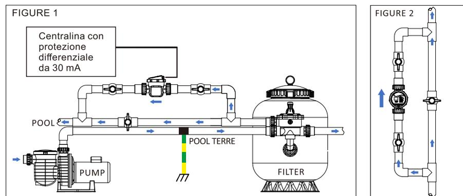
**Per installare l'elettrolizzatore su un tubo esistente (o l'ingombro sul tubo) occorre una lunghezza di taglio di 230 mm**
