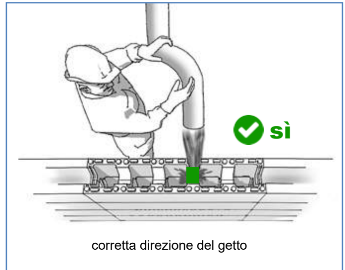
Procedura per il getto di C.A. all'interno dei casseri
